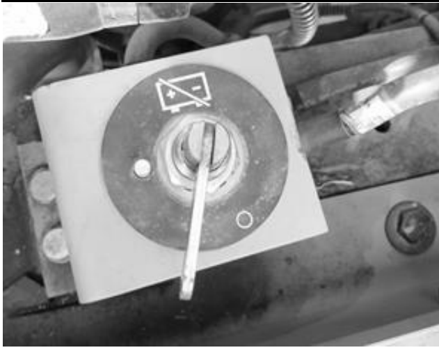
Схема выключатель "массы" аккумуляторной батареи
